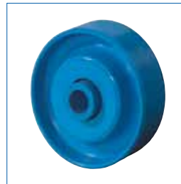
Räder aus Polyamid (Nylon) mit Kugellager, Lagerschalen einsatzgehärtet, für Röllchenbahnen
