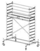
Arbeitshöhe: 4,40 m Gerüsthöhe: 3,40 m Standhöhe: 2,40 m
