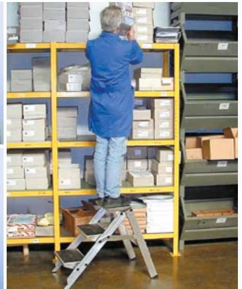
2) KlappTreppe mit klappbarem Bügel (Variante 2, zusammengeklappt 0,12 m)
