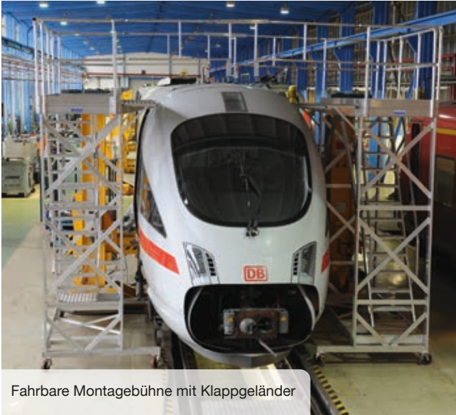
Laufboden mit Rammschutz und klappbarem Geländer
